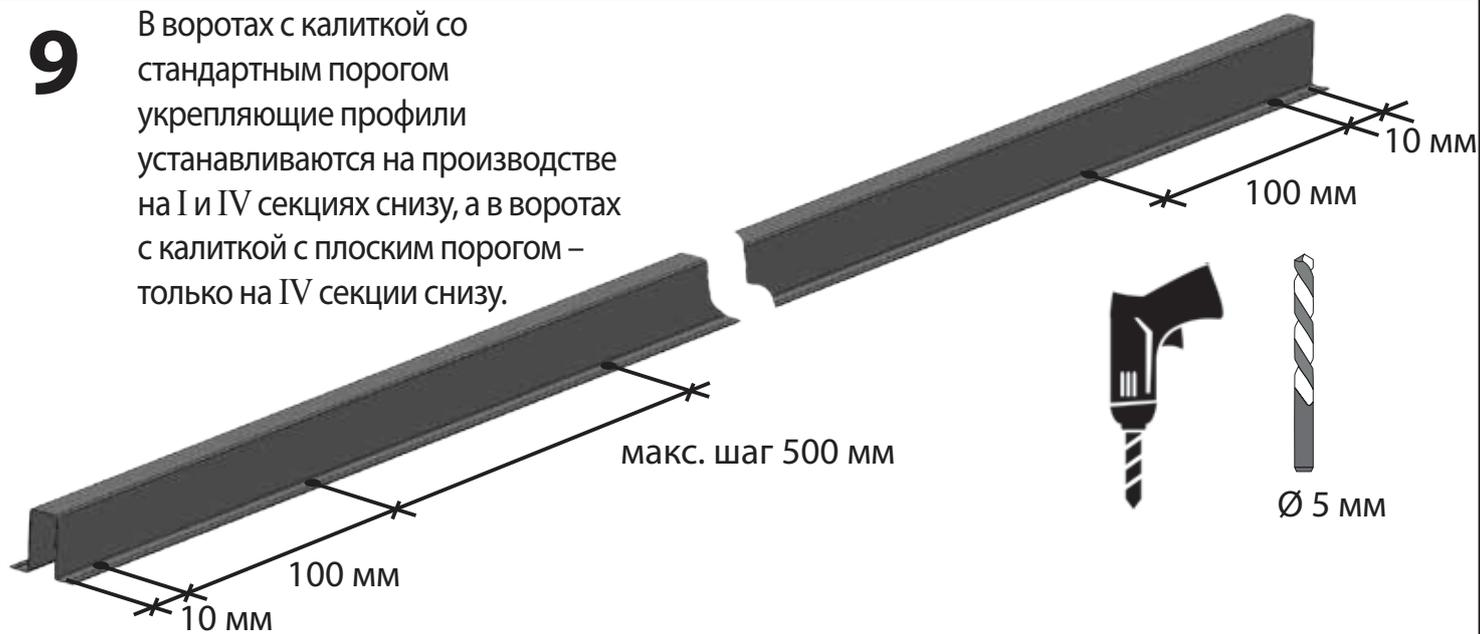
Укрепляющие профили (24) установить на сэндвич-панели в соответствии со схемой, прилагаемой к документации с воротами.
