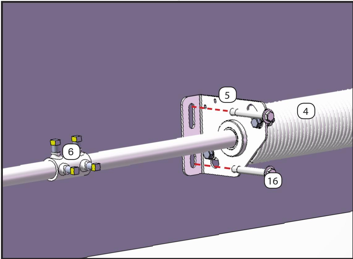
показана система с двумя валами, соединенными муфтой. В зависимости от размера ворот комплектация может быть с единым валом без муфты и с одной пружиной
