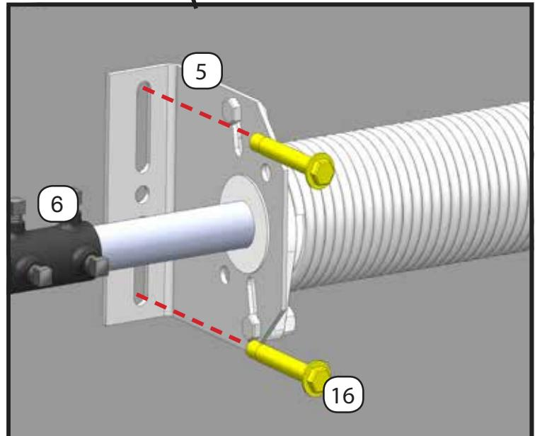
показана система с двумя валами, соединенными муфтой. В зависимости от размера ворот комплектация может быть с единственным валом без муфты и с одной пружиной
