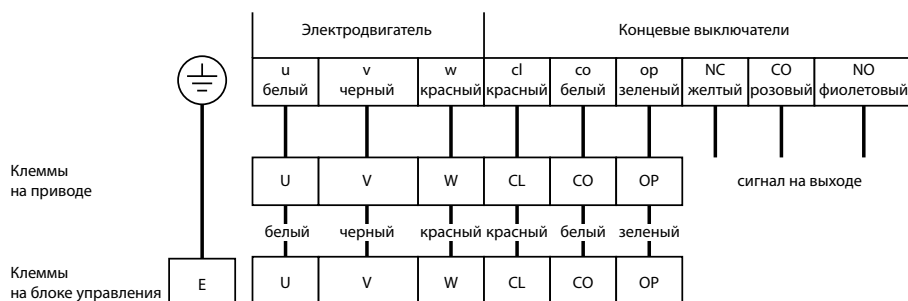
Рис. 9 Схема подключения привода
